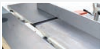
• Mesas cepilladora en fundición, guía cepillar inclinable
