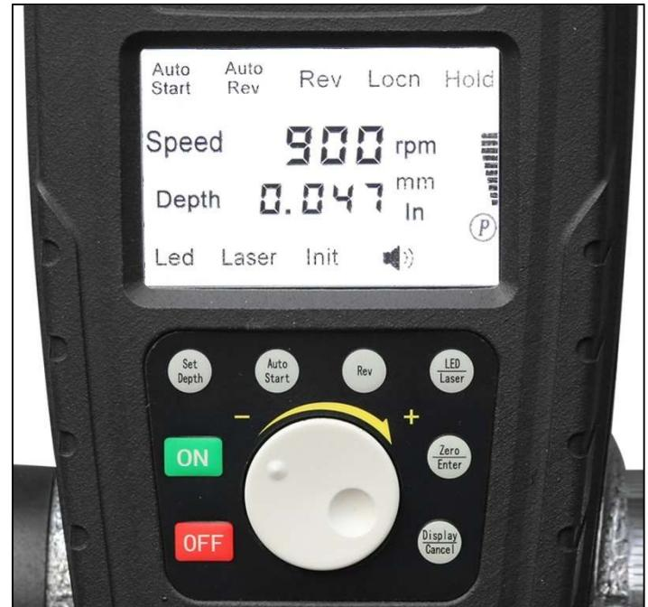
**5.2 Arranque y parada automáticos.** Se enciende automáticamente al bajar la broca y se detiene automáticamente al volver a su posición original. Al activar esta función, la máquina puede utilizarse cíclicamente sin necesidad de encenderla y apagarla manualmente durante el funcionamiento.
